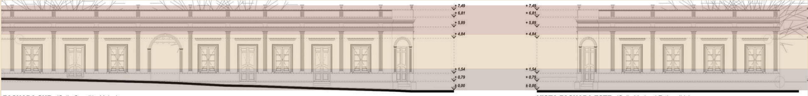
Fig. 3 • Fachadas sur (Capellán Molas) y este (Mcal. Estigarribia), con la lectura tripartita a partir de las cotas del relevamiento.
